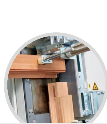
Eckverbindung Schlitz/Zapfen Corner connection slot/tenon
