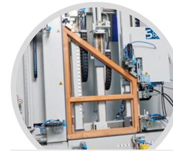
Trapezrahmen mit Kämpfer Trapezoidal frame with horizontal impost
