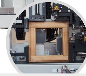
Kleinstmaßzulagen zum Verpressen von Rahmen bis ca. 380 x 380 mm Accessory set for minimum sizes for pressing frames to approx. 380 x 380 mm
