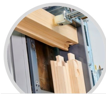
Eckverbindung Stemmzapfen Corner connection PlugTec
