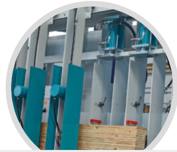
Zulagen für die Druckmittelpunktausrichtung schmaler Werkstücke Centering plates for centre point adjustment for narrow work pieces
