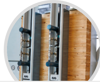
Niederhalter-Einrichtung mit Hydraulikzylindern Side clamp with hydraulic cylinders
